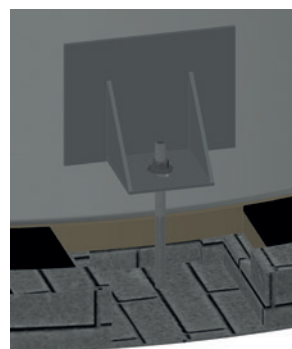
HASTE FIXADA NO CONCRETO S/Esc.
